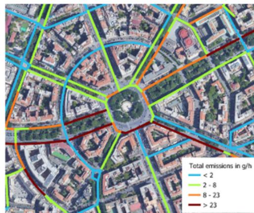
Figura 4a. Roma Piazza Mazzini. L'elaborazione evidenzia il totale delle emissioni espresse in g/h (per gli inquinanti: PM10 e NOx), calcolato a partire dai dati di flusso del traffico nell'ora di punta, nella fascia delle ore 8-9.
